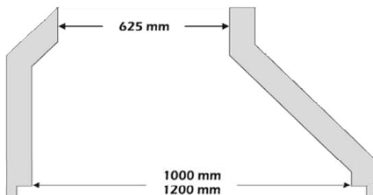
**Für Schachtfertigteile rund**
